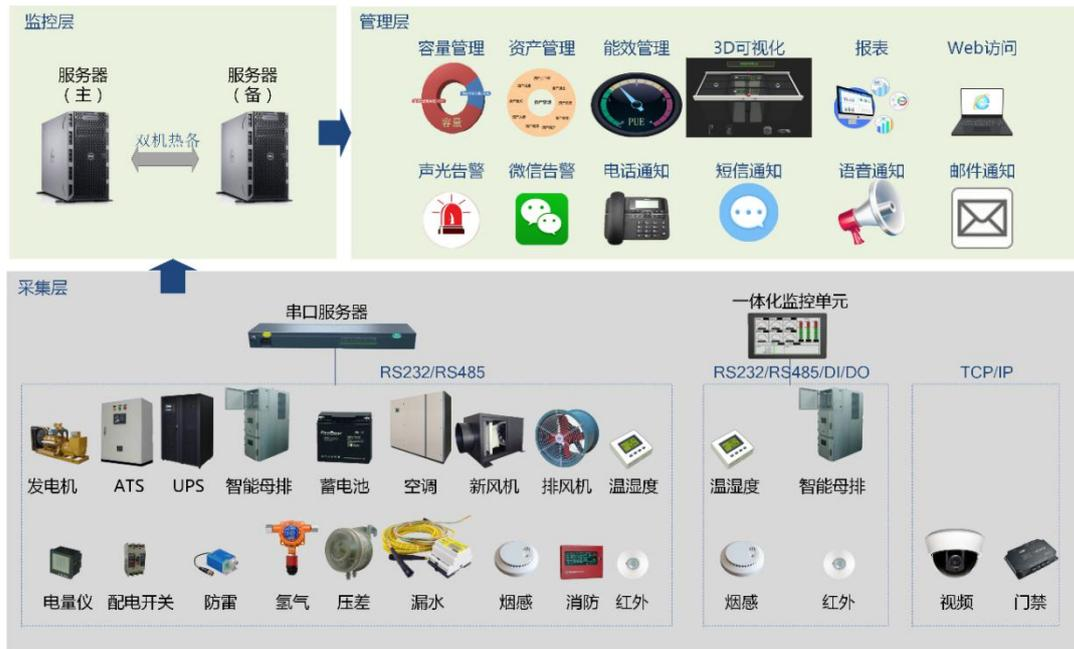
可实现：电量仪监测、配电开关监测、UPS 监测、空调监控、温湿度监测、漏水监测、消防告警监测、入侵监测、门禁管理、视频监控、微模块监测、冷通道管理等功能。
